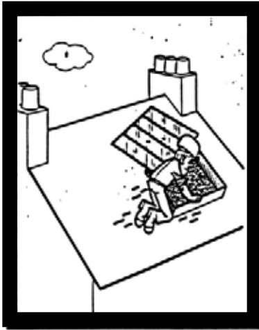
Hình 5.1. Nguy cơ bị trượt ngã vì không có dây an toàn
