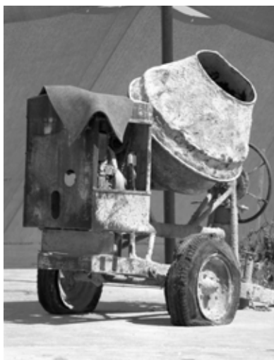
Hình 4.1. Máy trộn bê tông quá cũ nhưng vẫn được sử dụng
