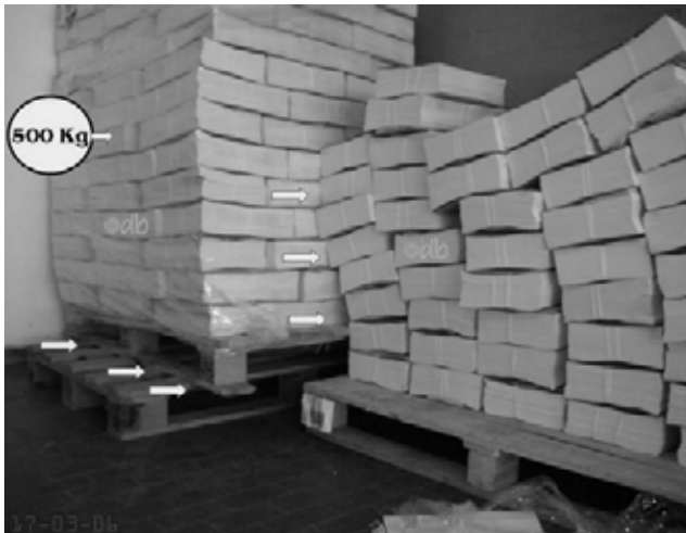
Hình 3.9. Khối vật liệu được xếp không ổn định
