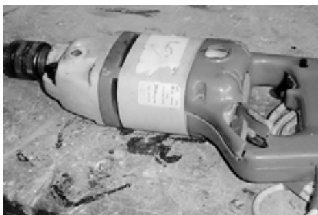
Hình 4.11. Máy khoan bị hỏng chất cách điện
