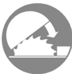
Hình 5. Biển báo hiệu bắt buộc sử dụng thiết bị bảo vệ tại lưới cửa máy
