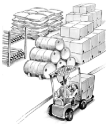
Hình 3.11. Minh họa cách xếp vật liệu xây dựng đúng phương pháp
