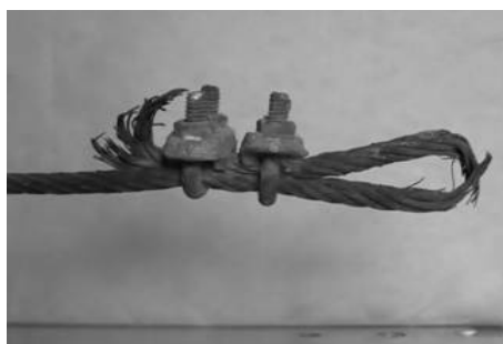
Hình 4.25. Dây cáp không tốt, có khả năng gây nguy hiểm khi làm việc
