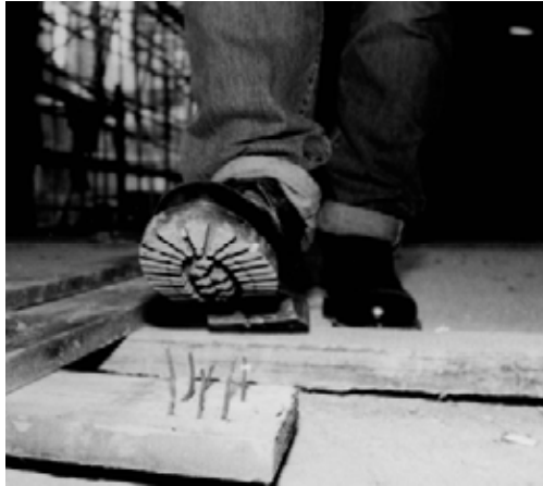
Hình 1.4. Hình ảnh mô tả giày đế cứng không bị đinh xuyên thủng
