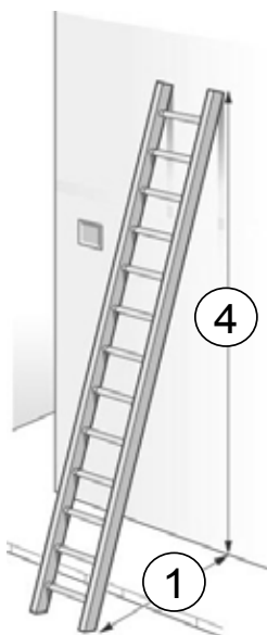
Hình 5.28. Dụng thang hợp lý - góc nghiêng 75^{\circ}
