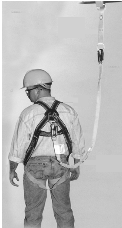
Hình 1.9. Cách đeo dây an toàn ở phía sau cơ thể người công nhân
