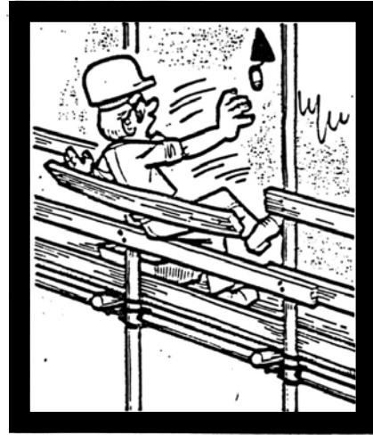
Hình 5.14. Sử dụng giàn giáo không có lan can an toàn và lan can an toàn lỏng lẻo
