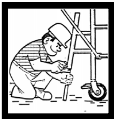
Hình 5.27. Cố định chân thang nổi xuống nền và hệ thống phanh bánh xe ở chân thang
