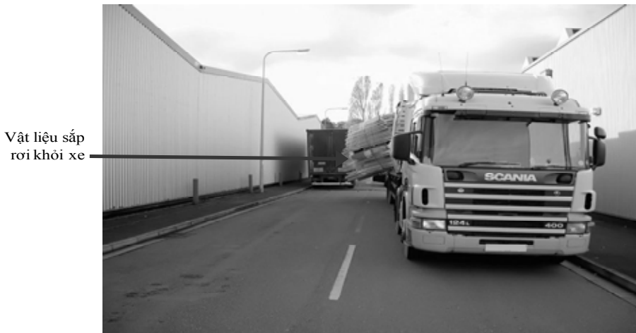
Hình 4.31. Vật liệu sắp rơi khỏi xe trong quá trình vận chuyển
